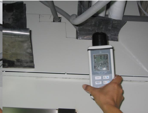
以鉛皮鋪設冰水管路下方劑量降至: 1.13 \mu\text{Sv/h}
