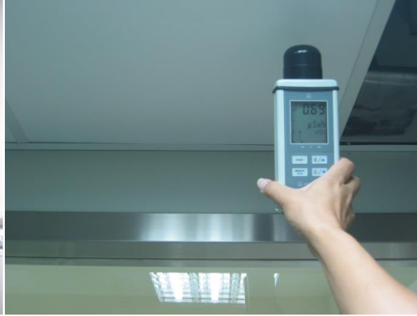
廠商隨意以鉛皮檔住出口情形 控制台鉛玻璃上方: 0.65 \mu\text{Sv/h}
