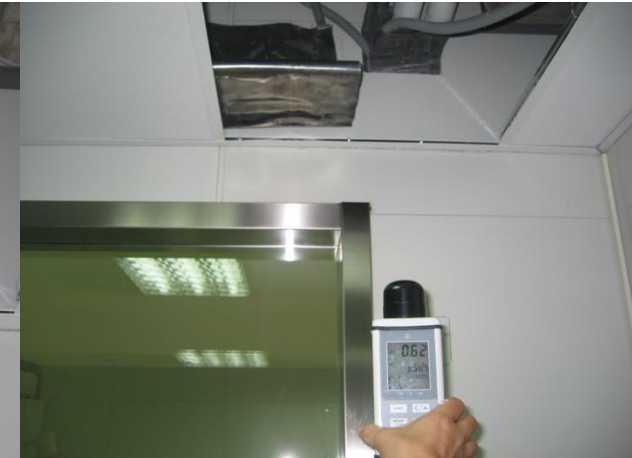
以鉛皮鋪設冰水管路下方劑量降至: 1.13 \mu\text{Sv/h}
