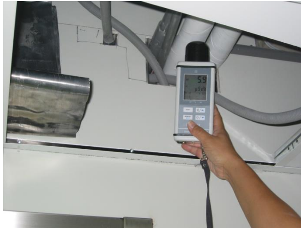
23:50:46 冰水管路出口仍有: 5.9 \mu\text{Sv/h}
