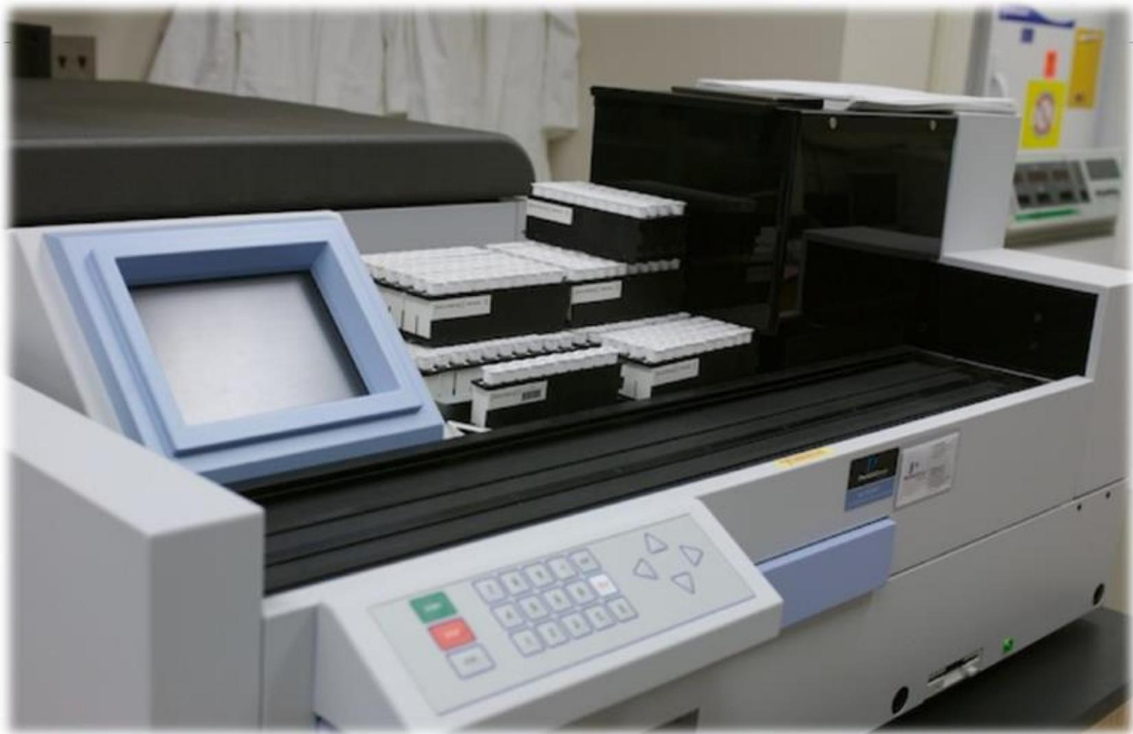
圖：井型式的閃爍計數儀「自動加馬計數儀」系統
